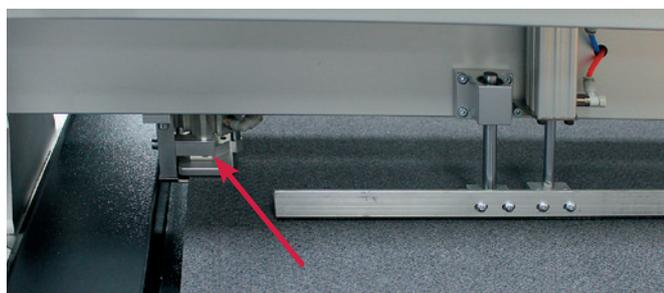
В модели ВК4 конвейер движется с помощью специальных захватов (один из них показан стрелкой), установленных на портале; таким образом при движении портала конвейер и обрабатываемый материал движутся синхронно
