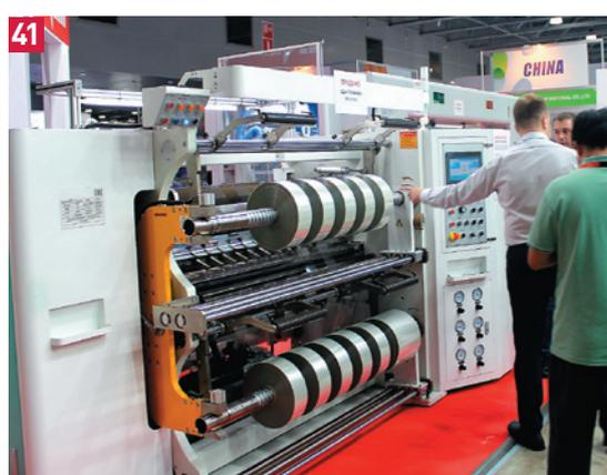
**370-COMPACT** — продольно-резательную машину с системой привода от четырёх сервомоторов.
