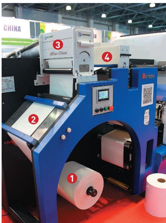
На размотке пневматический подъёмник для рулона (1) входит в стандартную комплектацию.
