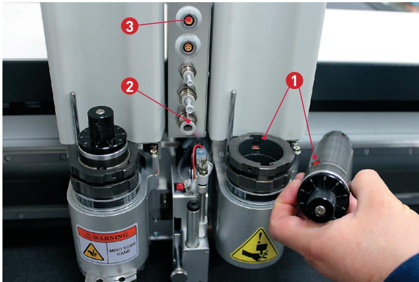
Инструменты у плоттеров iECHO универсальные: в любой модуль можно установить любой из инструментов. При этом возможна «горячая» замена: при смене инструмента выключать машину не нужно.
