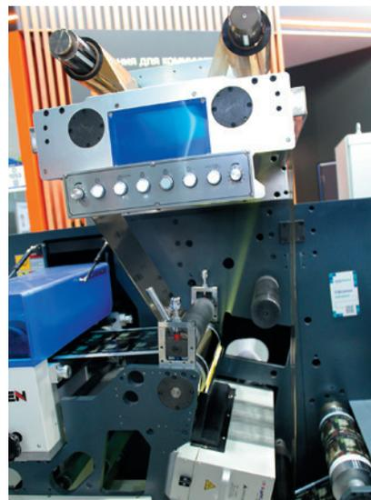
Валы с фольгой и перенос металика на обрабатываемый материал под УФ-сушкой методом холодного тиснения
