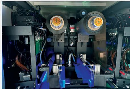
Для корректной работы промежуточных и основной УФ-сушки, а также охлаждающего вала применяется система охлаждения. Рядом с ней располагается блок управления коронатором
