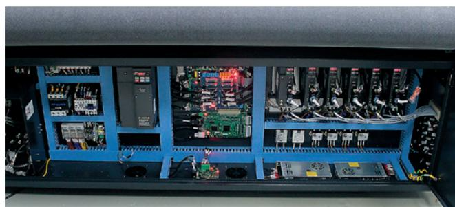
Электроника, управляющая плоттером: в центре — материнская плата компьютера, который служим «мозгом» машины
