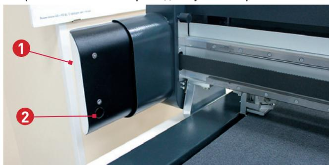
Система безопасности включает как механические устройства (1), так и лазерный барьер (2), установленные с обеих сторон портала и надёжно защищающие оператора от столкновения с движущимся рабочим узлом
