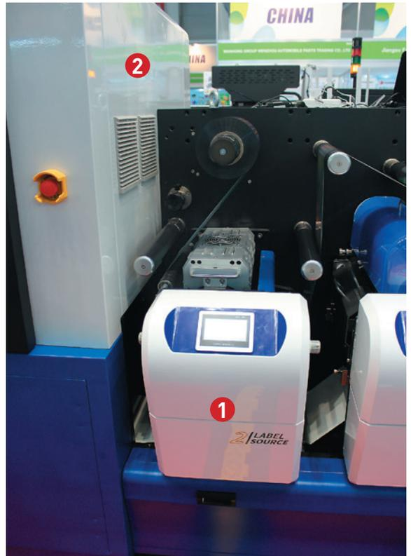
В секции (1), расположенной после цифрового печатного модуля (2) в данной машине, производится горячее тиснение
