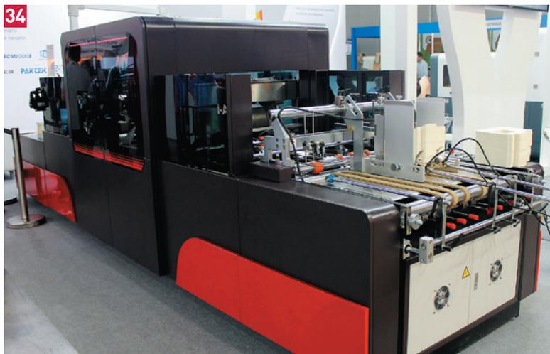
Новинка в ассортименте **ГК «РУССКОМ»** — планшетный режущий плоттер с автоподачей **MasterCutter 1070 GT**. Среди плоттеров такого типа он выделяется достаточно большим форматом: площадь резки составляет 100×70 см. Толщина обрабатываемых материалов — до 2 см. Благодаря таким характеристикам делать на нём можно самую разнообразную продукцию: от бумажных конвертов и виниловых наклеек до коробок из гофрокартона, резиновых и пластиковых изделий.
