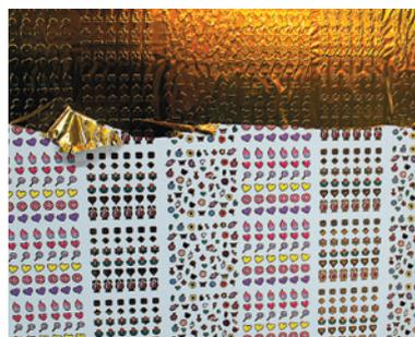
Если изображение небольшое и цельное, то после фольгирования оно готово к переносу на предметы: остаётся вручную отделить бумажную подложку. Если же изображение большое и с пробелами, плёнку В (как при обычной DTF-UV-печати) придётся всё же нанести: это делается на обычном ламинаторе
