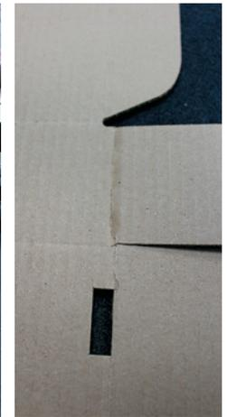
Для изготовления коробки на плоттере была вырезана заготовка из гофрокартона. Для этого использовались нож и биговальный инструмент колесного типа.
