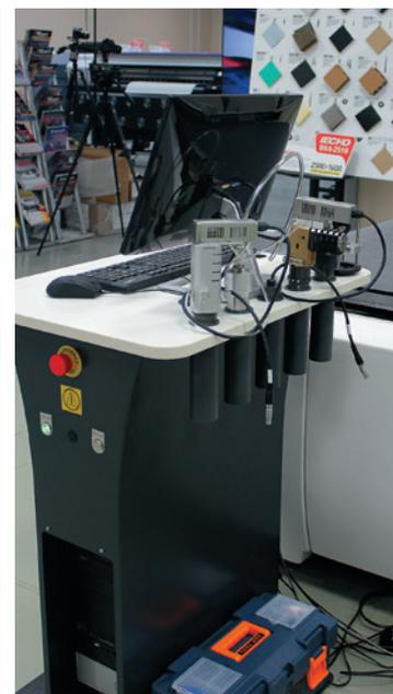
Оptionальная стойка управления позволяет разместить управляющий компьютер и монитор, также на ней имеются специальные ячейки для хранения инструментов
