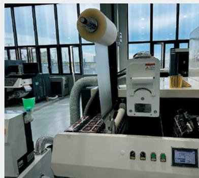
Опционально в линию можно установить модуль ламинации скотчем с приводом
