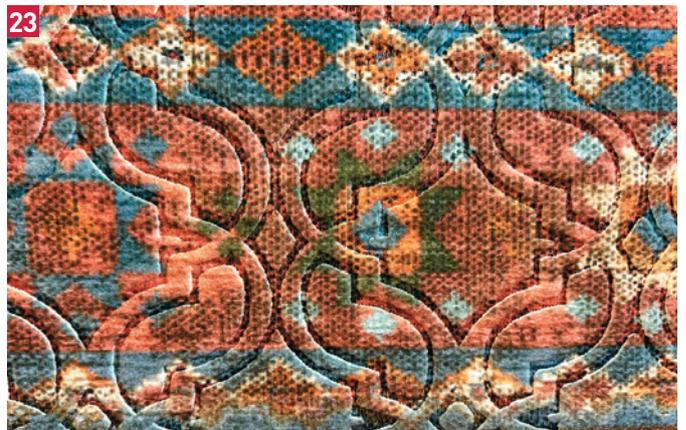
ных сетчатых шаблонов — так наносят контур изображения металлизированными пастами. Далее ткань сушат и подают для цифровой печати, с помощью которой внутрь обозначенного контура наносят изображение нужного цвета **18** и **19**. Насколько такой способ печати будет востребован? Трудно предсказать, уж очень специфичным по тактильным ощущениям получается рисунок.
